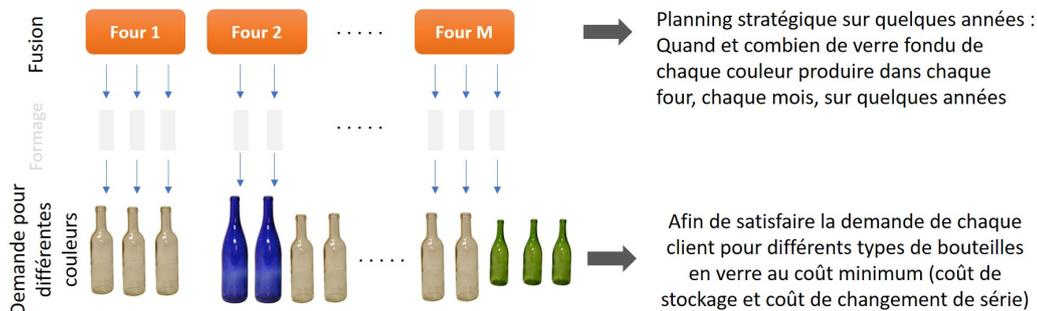
FIG. 1 – Système de fours identiques et parallèles pour la fabrication de bouteilles en verre.
